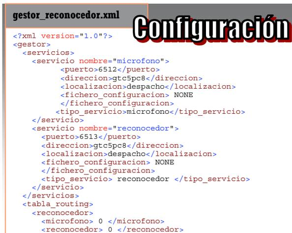
Figura 6. Ejemplo de fichero de configuración de un sistema con la arquitectura EDECÁN.
